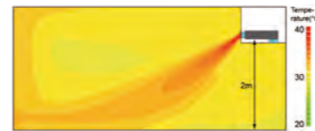
Impulsión de aire con Auto Louver.
